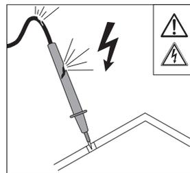
Rischio di scossa elettrica. Sonde guaste che non assicurano l'isolamento. Sostituite periodicamente le sonde di misura.
