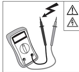
Rischio di scossa elettrica. Strumento non idoneo alla misurazione a causa di una tensione maggiore del consentito. Utilizzate uno strumento adatto allo scopo.
