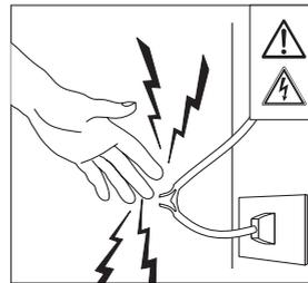
Rischio di scossa elettrica. Non toccate le parti in tensione elettrica e mantenete una distanza di sicurezza. Indossate guanti isolanti.
