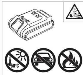
Temperature elevate provocano l'esplosione delle batterie.
