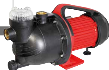
1370637 ELETTROPOMPA AUTOADESCANTE ACQUE CHIARE JET PJ-900/F 900W. Prevalenza max 45m. Aspirazione max 7m. Portata 3500 l/h. Prefiltro.
