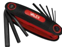
1461778 CHIAVI MASCHIO ESAGONALI SERIE 8 PEZZI CRV Misure: 1,5-2-2,5-3-4-5-6-8mm. Lunghezza 45-65mm. Corpo in acciaio cromo vanadio.
