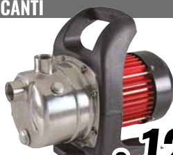
1370636 ELETTROPOMPA AUTOADESCANTE ACQUE CHIARE JET PJ-INOX1202 1200W. Prevalenza max 46m. Aspirazione max 8m. Portata 3500 l/h.
