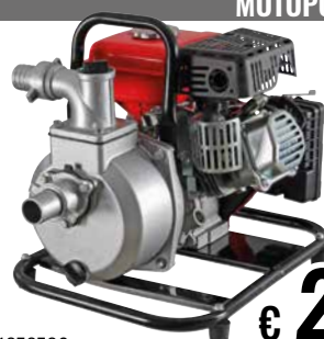
1370709 MOTOPOMPA AUTOADESCANTE 4 TEMPI ACQUE TORBIDE MP17000 93cc. Portata max 17000 l/h. Prevalenza max 22m. Aspirazione max 7m. Attacco tubi da 1,5" con riduttore universale.
