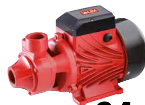
1370639 ELETTROPOMPA PERIFERICA ACQUE CHIARE PJ371B 370W. Prevalenza max 36m. Aspirazione max 8m. Portata 2160 l/h.
