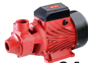
1370640 ELETTROPOMPA PERIFERICA ACQUE CHIARE PJ551 550W. Prevalenza max 45m. Aspirazione max 8m. Portata 2700 l/h.
