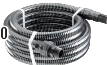
1105741 TUBO DI ASPIRAZIONE PER ACQUA SPIRALATO Tubo da collegare all'aspirazione delle pompe centrifughe. Valvola di fondo antiritorno con filtro. Attacco filettato 1" maschio con guarnizione.
