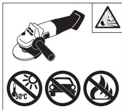
Temperature elevate provocano l'esplosione delle batterie. Non esponetele ai raggi diretti del sole, non lasciatele dentro i veicoli, non bruciatele.
