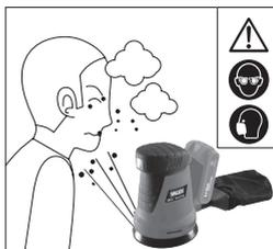
Lancio di materiale verso gli occhi ed il corpo dell'operatore. Indossate occhiali di protezione e maschera antipolvere.
